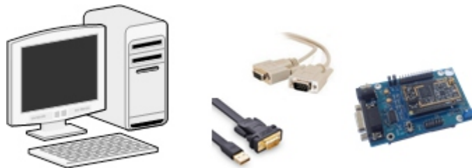
图8 评估底板与电脑连接图
